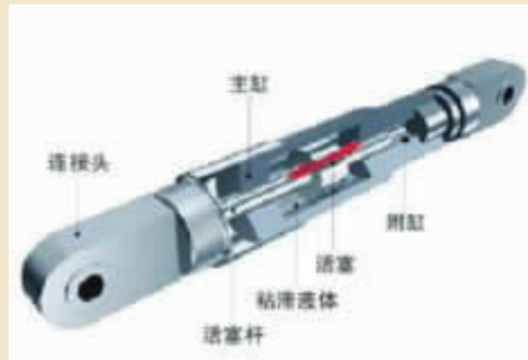
液压阻尼器结构图
